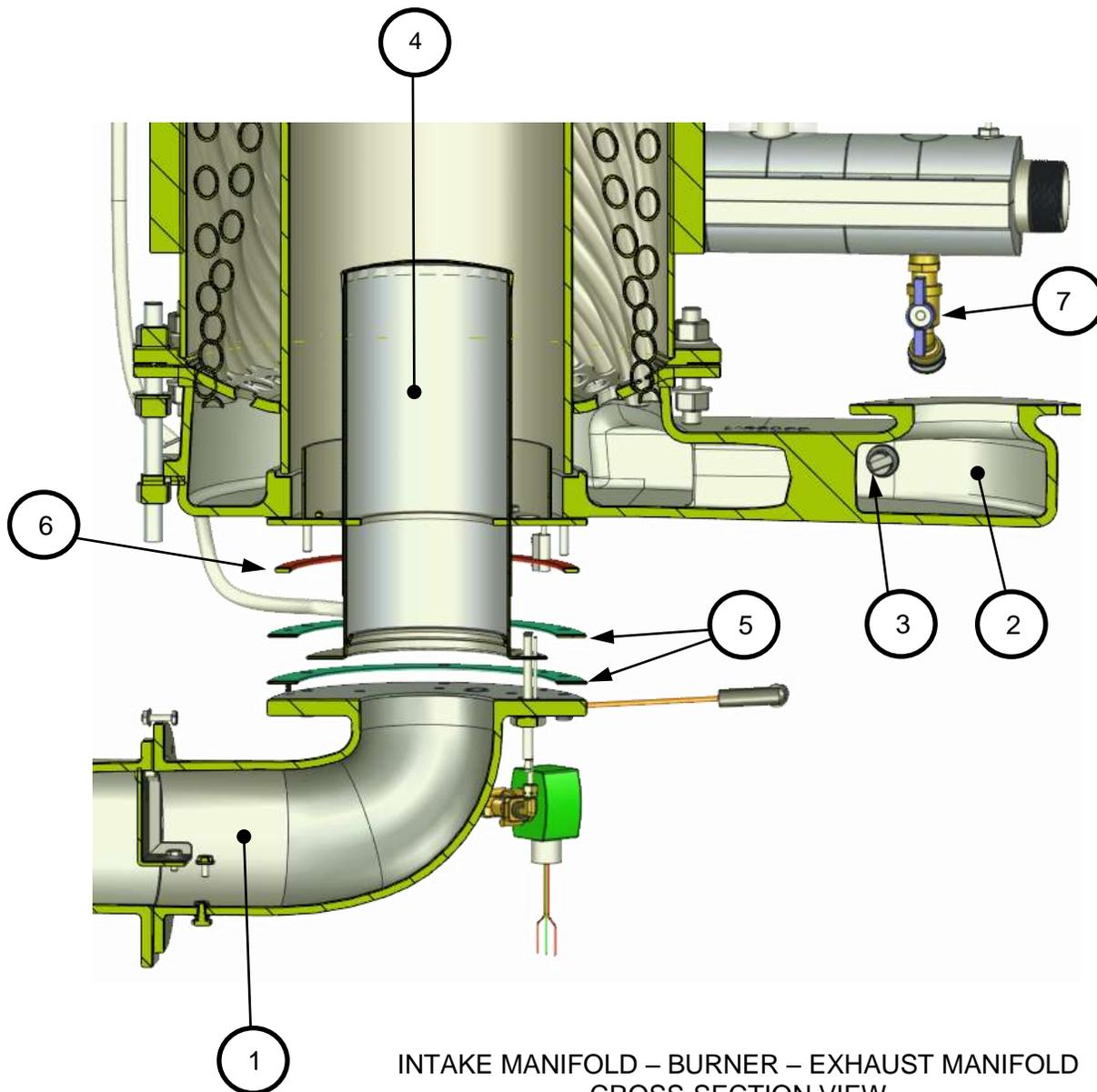
INTAKE MANIFOLD – BURNER – EXHAUST MANIFOLD
