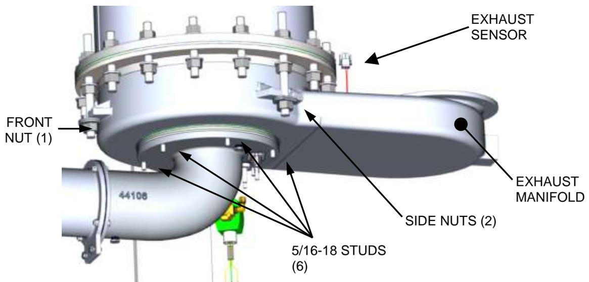
**PARTIAL RIGHT-SIDE VIEW WITH SUPPORT REMOVED**
