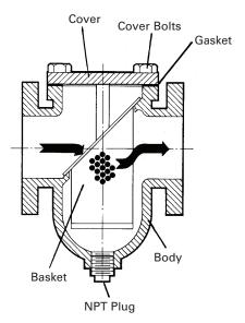
SIMPLEX BASKET STRAINERS SHOULD BE INSTALLED IN THE POSITION SHOWN IN THE ILLUSTRATIONS ABOVE
